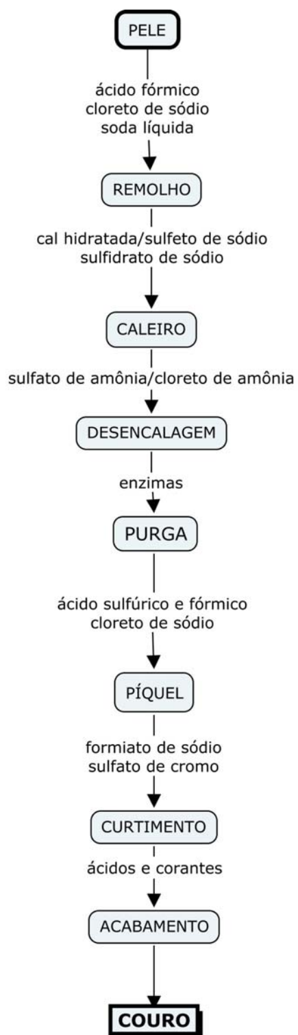
Figura C.1 – Fluxograma das etapas do processo de produção do couro.
