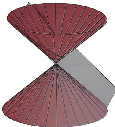
Figura 20: Parábola obtida seccionando-se um cone com um plano
