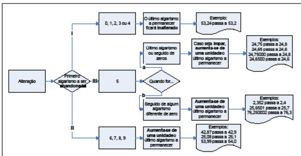
Figura 17: Arredondamento: Fluxograma
