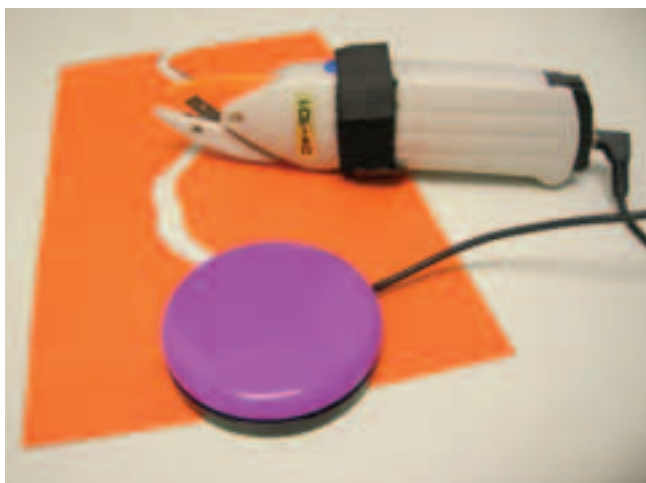
Figura 5 - Tesoura elétrica ativada por acionador.
