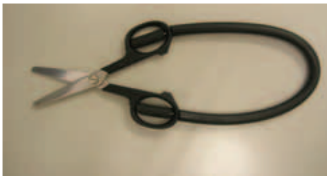
Figura 1 - Tesoura adaptada com arame revestido.
