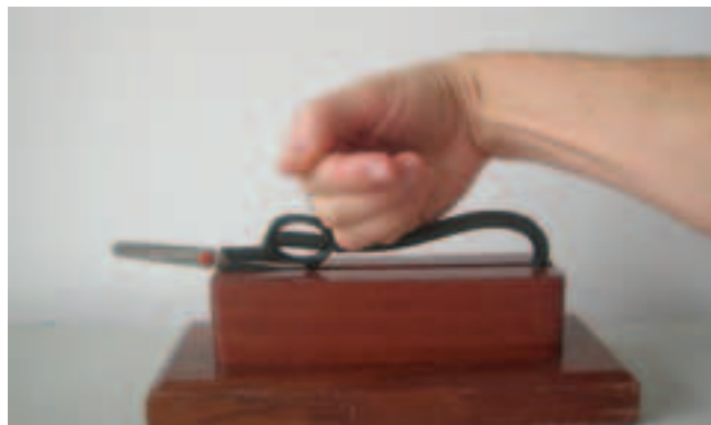
Figura 4 - Cortando com a tesoura em suporte fixo.
