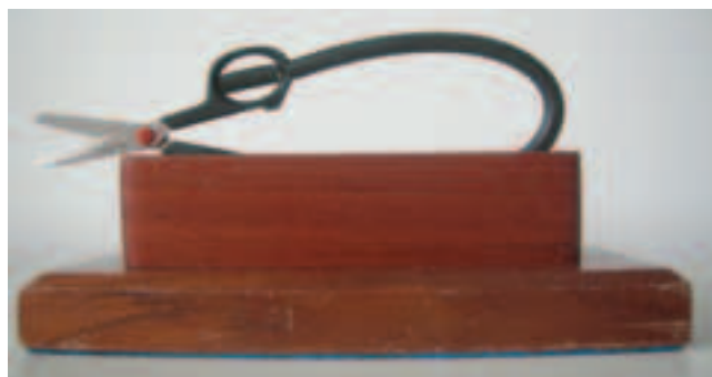
Figura 3 - Tesoura adaptada em suporte fixo.
